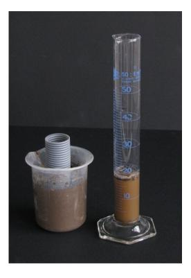
REPEAT THE FORMER OPERATIONS, PUSHING EACH TIME THE MICROSIEVE CYLINDER A LITTLE FURTHER DOWN INTO THE WATER/SOIL MIXTURE, UNTIL NO SUPERNATANT PENETRATES ANYMORE INTO THE MICROSIEVE
